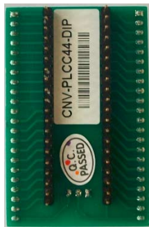
PLCC-44的转换座(反面)
