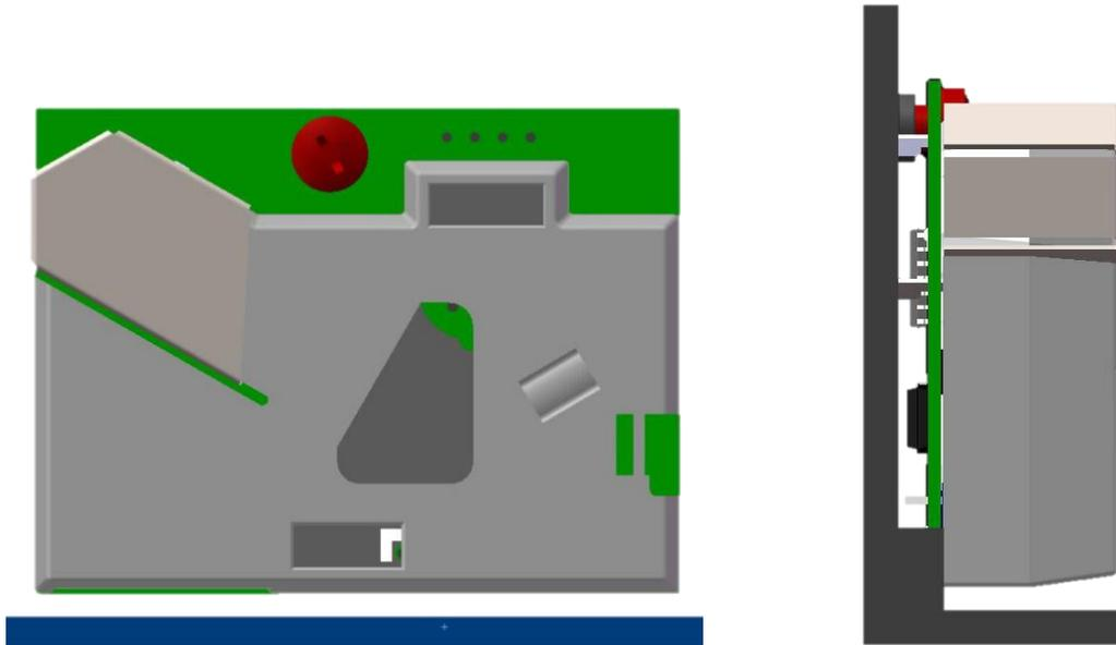
1.2 保证探测气路顺畅 外部气流可以平顺进入传感器光学腔体并及时排出。当应用于空气清新机时，风扇的进出气流都不能影响传感器探测气路的稳定性，可任选机体一侧安装。
