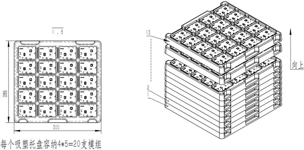
图7 吸塑托盘容纳传感器
