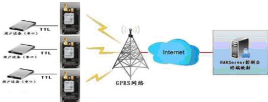
图4. GM-EVK 通过 HARServer 控制台映射实现点对点（串口对串口）
