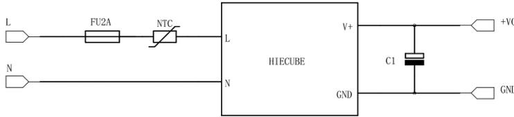
(注：NTC 型号是：10D-11，抑制浪涌电流。C1 是电解电容。(可参照外围元件选型表))
