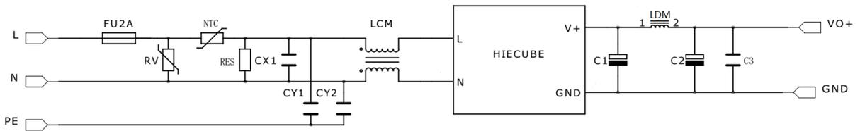
注：元件参数参考规格书的EMC低纹波电路
