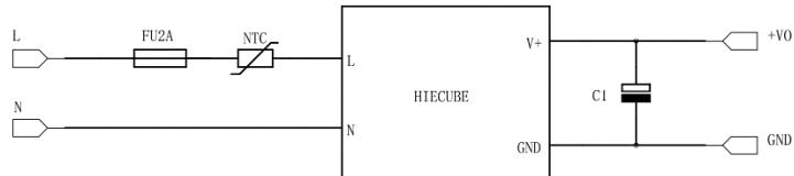
(注：NTC 型号是：10D-11，抑制浪涌电流。C1 是电解电容。(可参照外围元件选型表))
