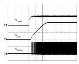
CH1:  $V_{\rm COMP}$ , 1V/Div CH2:  $V_{\rm OUT}$ , 500mV/Div CH3:  $V_{\rm PHASE}$ , 10V/Div Time: 500 $\mu$ s/Div
