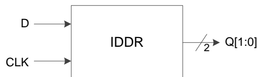
图 3-13 I/O 逻辑的 DDR 输入示意图
