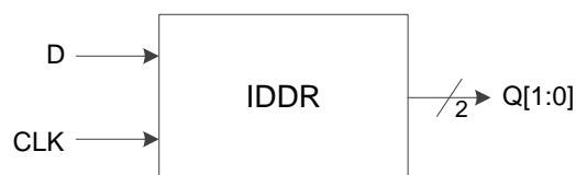
图 3-13 I/O 逻辑的 DDR 输入示意图
