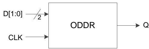
图 3-14 I/O 逻辑的 DDR 输出示意图
