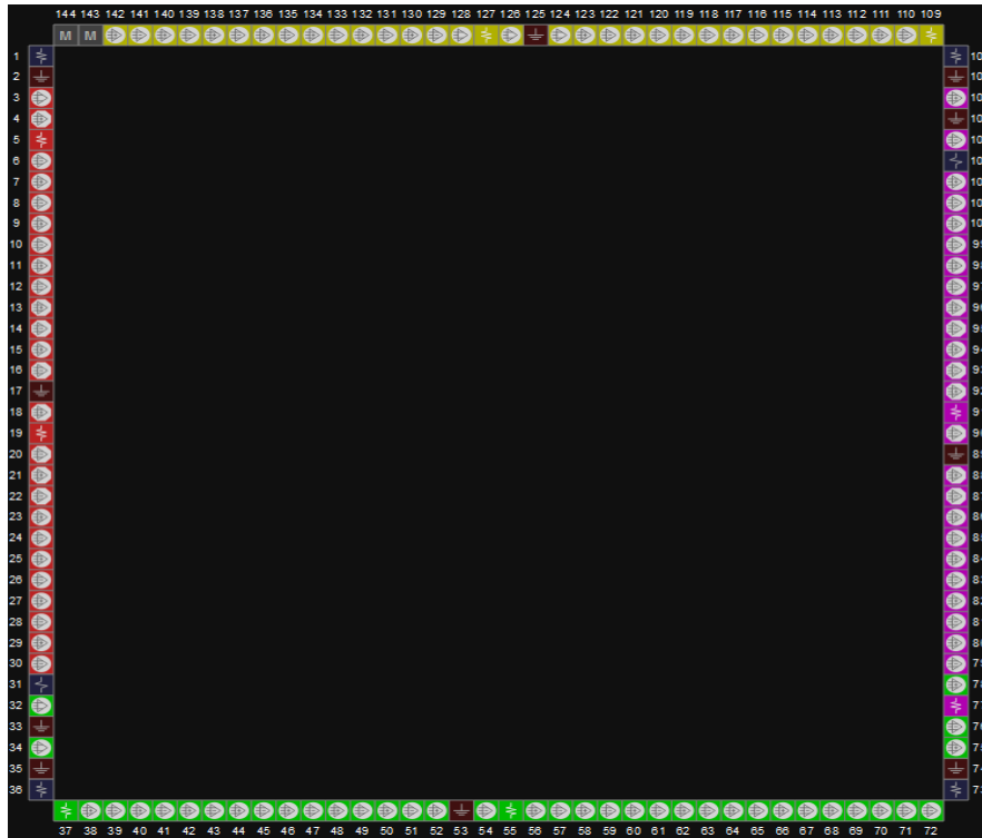
图 3-2 GW1N 系列器件 LQ144 封装管脚分布示意图（顶视图）
