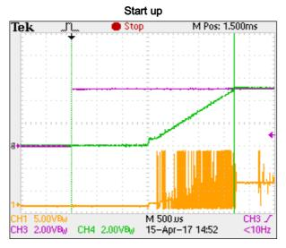
CH1= V<sub>SW</sub>, CH3=V<sub>EN</sub>, CH4=V<sub>OUT</sub>
