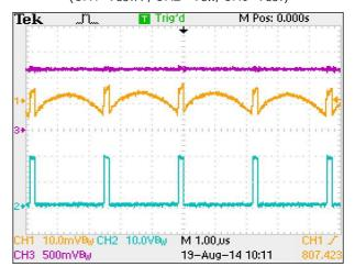
V<sub>IN</sub>=12V, V<sub>OUT</sub>=1.2V, I<sub>OUT</sub> =1.0A
