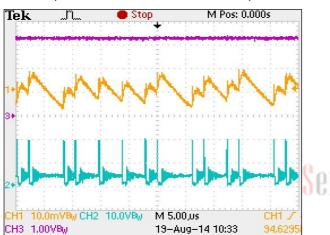
V<sub>IN</sub>=12V, V<sub>OUT</sub>=3.3V, I<sub>OUT</sub> =50mA
