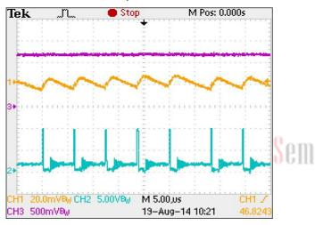
V<sub>IN</sub>=9V, V<sub>OUT</sub>=1.2V, I<sub>OUT</sub>=50mA
