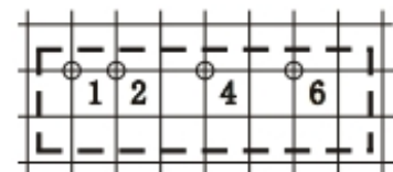
俯視圖，柵格間距 2.54mm 開孔直徑 1.00mm
