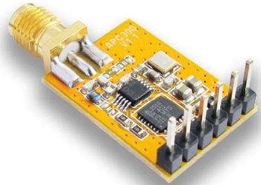
APC300模块能定时采集传感器数据并发送，模块可在2.1-3.6V电压范围内工作，在10dBm发射功耗仅仅14mA，休眠功耗低至1.5uA，合理的设定采集周期，通常一节普通的的锂亚电池(如ER18505)工作寿命可达数年至十几年。
