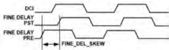
图 26 Pre 延时时钟和 Pst 延时时钟采样图
