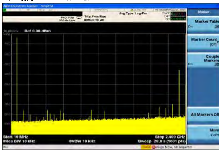
图 3 单音信号频谱， f_{OUT}=91\text{MHz} ， f_{DAC}=2.4\text{GSPS}
