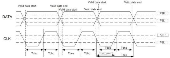
Timing parameter (VDD=3.3V, GND=0V, Ta=25C)
