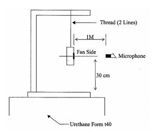
1 METER FROM MICROPHONE TO FAN INTAKE
