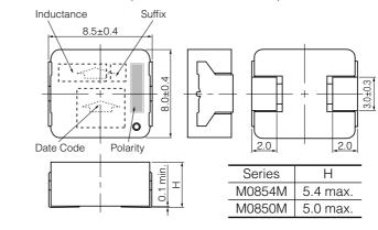
0+0 3.0±0. . O Date Code Polarity 0.1 min. 5.4 max Series PCC-M1054M
