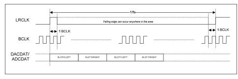
Figure 55 TDM in DSP Mode B
