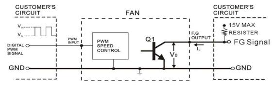
\*PWM INPUT FREQUENCY------FPWM:18KHZ~30KHZ
