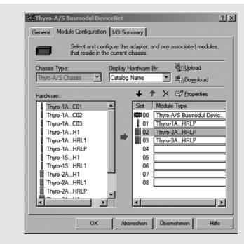
FIG. 5.3 MODULE CONFIGURATION
