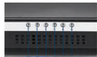
Power | Temp. | LAN1 HDD | Fan | LAN2
