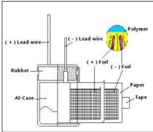
导针:固体镀锡铜包钢线
