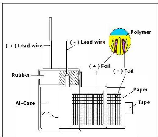
导针:固体镀锡铜包钢线
