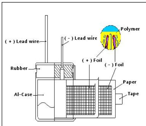
导针:固体镀锡铜包钢线
