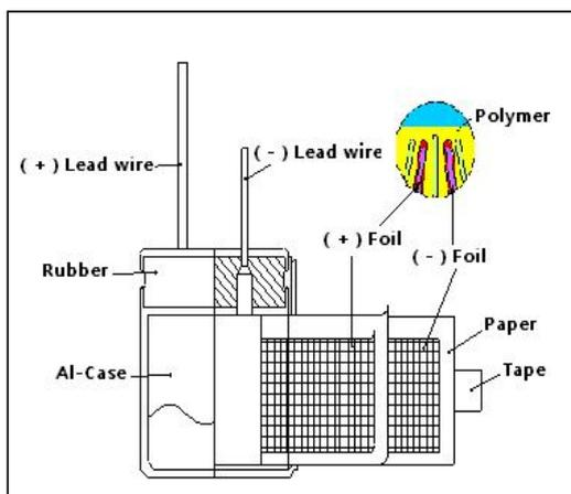
导针:固体镀锡铜包钢线
