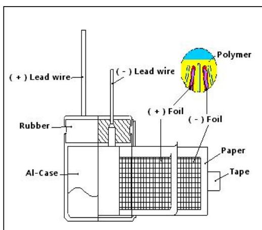
导针:固体镀锡铜包钢线
