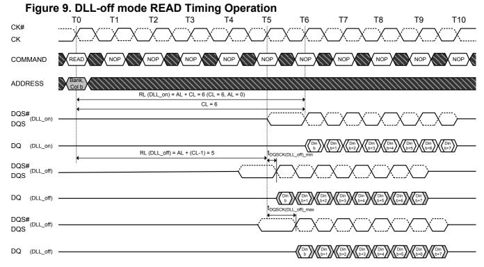
NOTE 1. The tDQSCK is used here for DQS, DQS# and DQ to have a simplified diagram; the DLL\_off shift will affect both timings in the same way and the skew between all DQ and DQS, DQS# signals will still be tDQSQ.
