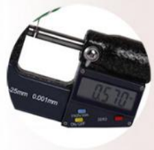
真正4N级别无氧铜导体符合23AWG=0.570mm(非0.56mm)
