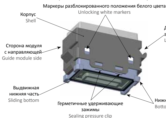
Модуль типа 1767 PA в разблокированном виде (для вставки и извлечения контактов) Unlocked 1767 PA module (for contacts insertion and extraction)
