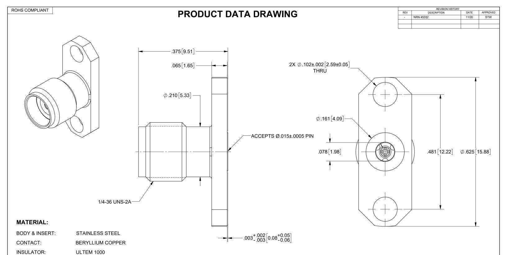
**BODY & INSERT: PASSIVATED** CONTACT: **GOLD OVER NICKEL**
