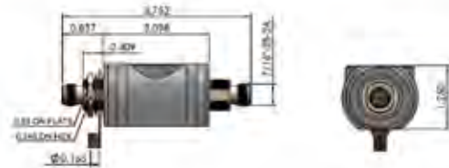
• LP-GPX-05-TFF 1000 - 2000MHz TNC Type F/F
