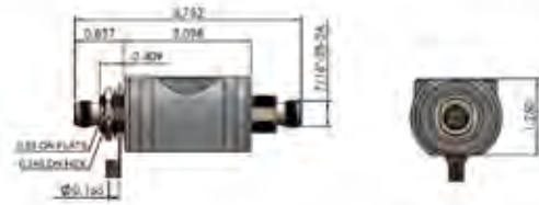
• LP-GPX-05-TFF 1000 - 2000MHz TNC Type F/F
