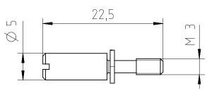
Material: Stahl, verzinkt material: steel, Zn-plated
