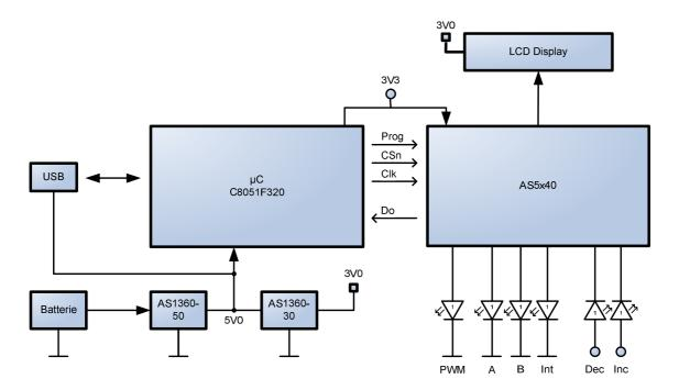
Figure 9: AS5x40 Blockdiagramm
