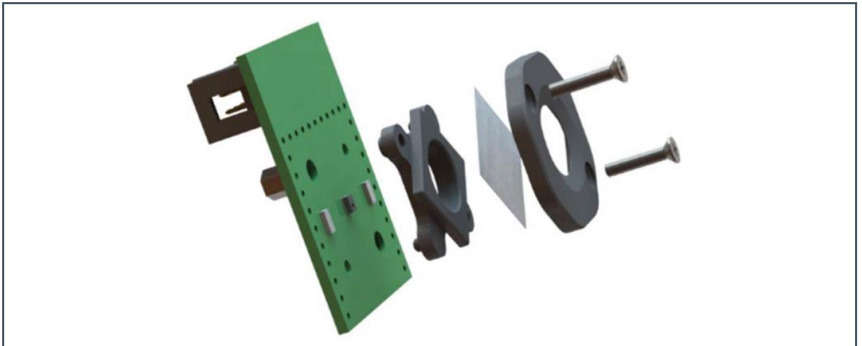
Figure 13: Installation of Diffusor Holder ALS 4
