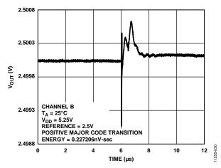
Figure 30. Digital-to-Analog Glitch Impulse
