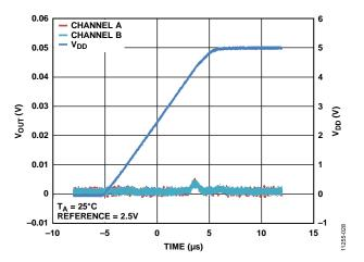
Figure 28. Power-On Reset to 0 V
