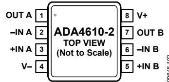
图5. ADA4610-2引脚配置，8引脚MSOP (RM后缀)
