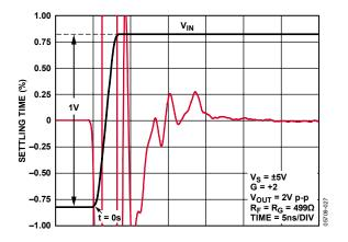
Figure 36. Settling Time Rising Edge
