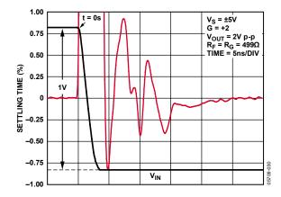
Figure 39. Settling Time Falling Edge
