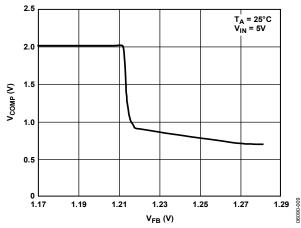
Figure 10. V<sub>COMP</sub> vs. V<sub>FB</sub>
