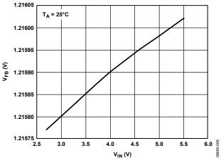
Figure 7. V<sub>FB</sub> vs. V<sub>IN</sub>
