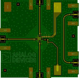
Figure 15. ADRF5132-EVALZ Evaluation Board Layout
