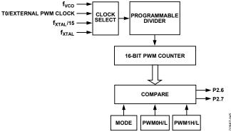
Figure 56. PWM Block Diagram
