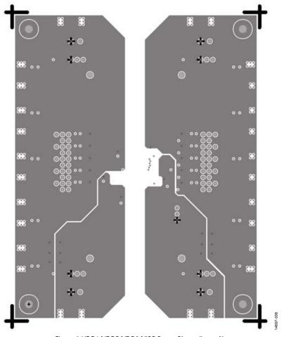
Figure 6. VDD1/VDDP/VDD2/VISO Power Planes (Layer 2)
