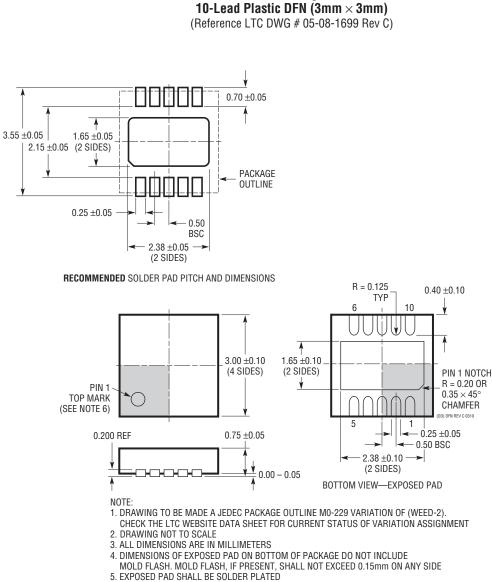
6. SHADED AREA IS ONLY A REFERENCE FOR PIN 1 LOCATION ON THE TOP AND BOTTOM OF PACKAGE
