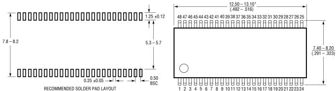
RECOMMENDED SOLDER PAD LAYOUT APPLY SOLDER MASK TO AREAS THAT ARE NOT SOLDERED
