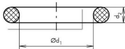
$$d_1=19\text{mm} \quad d_2=2\text{mm}$$
