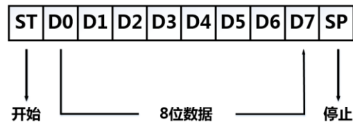
图 6 字符的发送和接收格式
