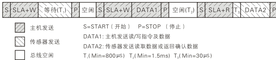
图 14: I 2 C 读写传感器完整示例图
