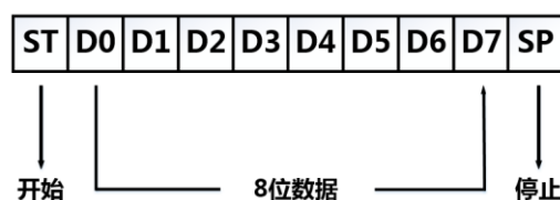
图 5 Modbus 通信格式
