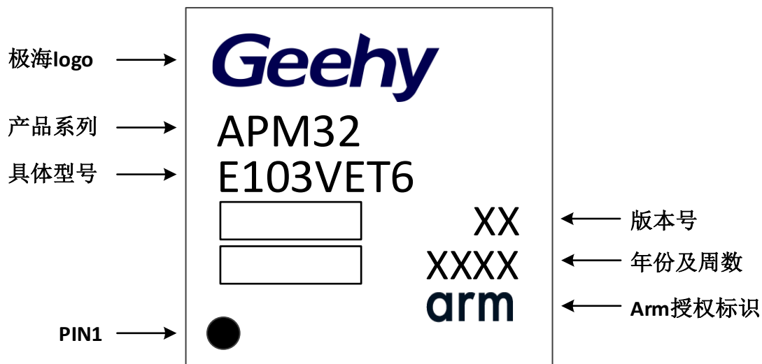
图 23 LQFP100 - 100 引脚，14 x 14mm 封装标识
