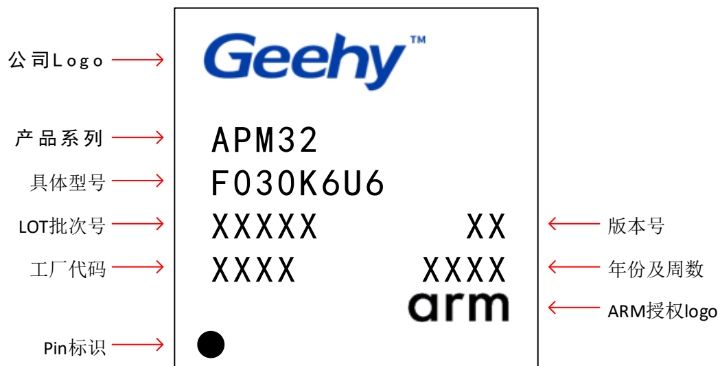
图27 QFN32 打码规范
