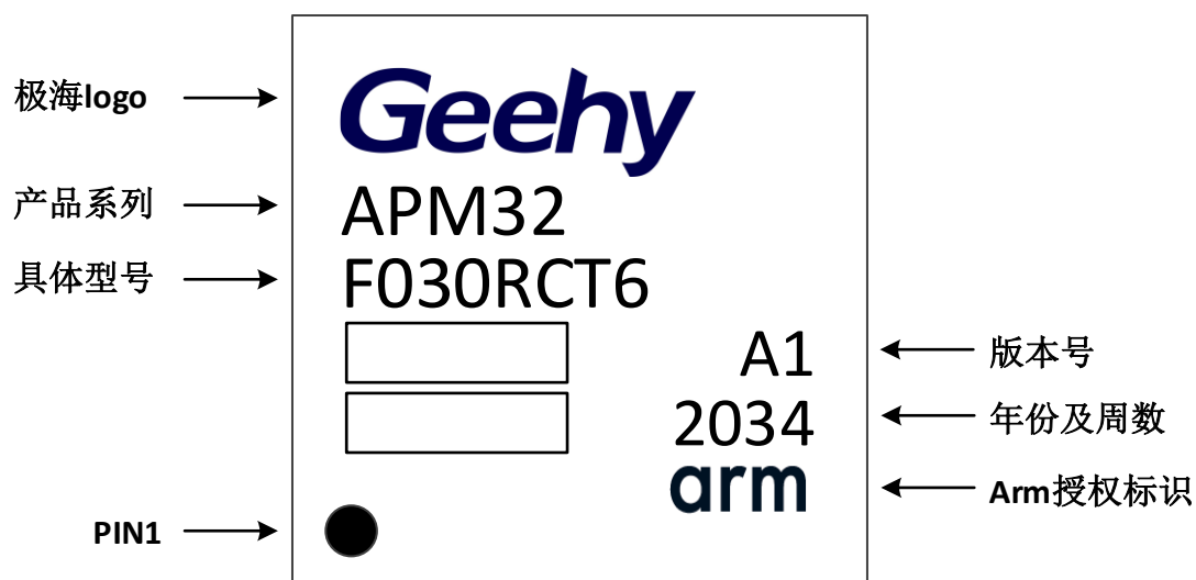
图 16 LQFP64-64 引脚，10×10mm 封装标识
